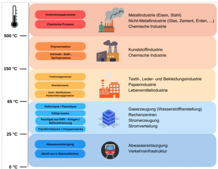
Abbildung 19: Temperaturniveau der Abwärme nach Industriezweigen Quelle: (Dunkelberg, 2023)
